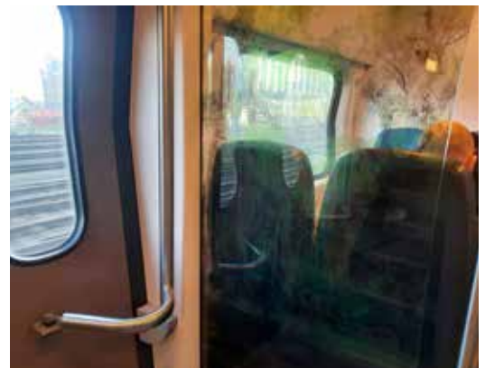
VIRM-trein: deze vaste stoelen op het portaal kunnen worden vervangen door klapstoelen en drie haken voor fietsen.
