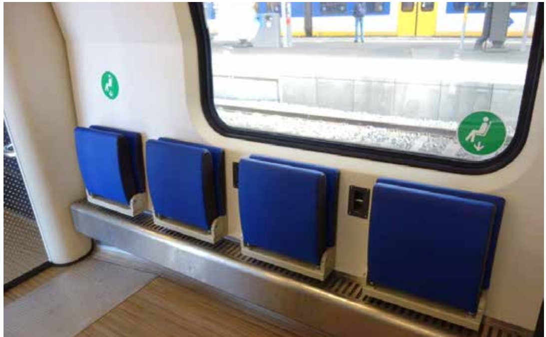
VIRM-trein: hier kunnen in de intercity vier fietsen geplaatst worden. Het linker klapstoeltje blijft dan nog over voor een passagier (bijvoorbeeld een fietser).
