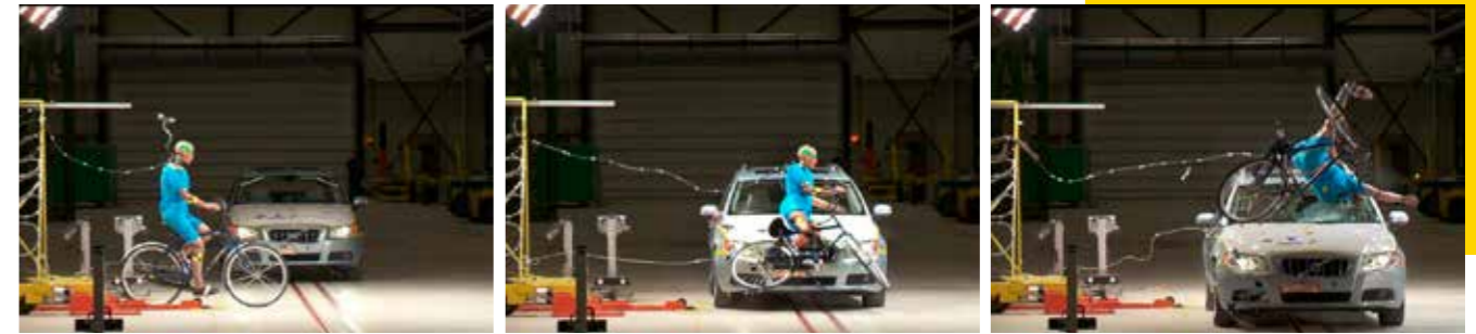
Crashtest met een airbag voor fietsers op de auto. © Foto: TNO
