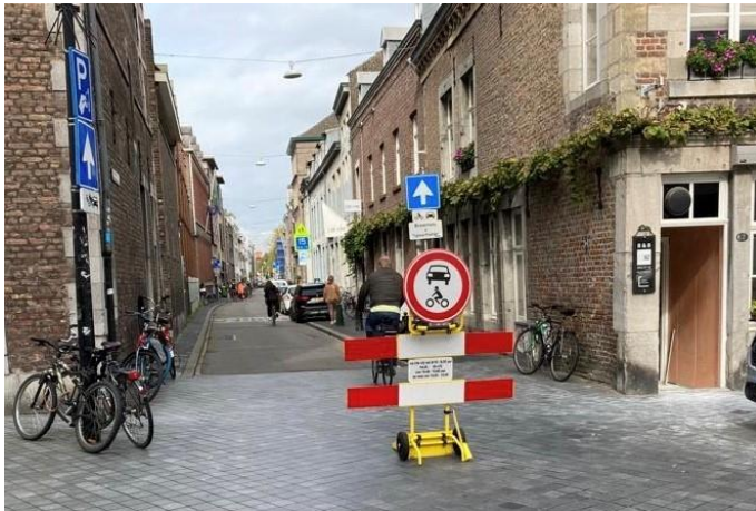
Figuur 3 Voorbeeld Maastricht van een steekwagen met daarop het wit-rode hek en bebording
